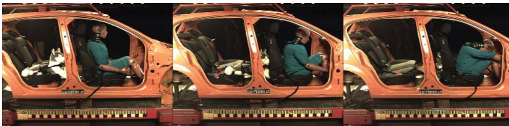
Crash-test avec ceinture de sécurité pour chien - mannequin-chien assuré des deux côtés.
