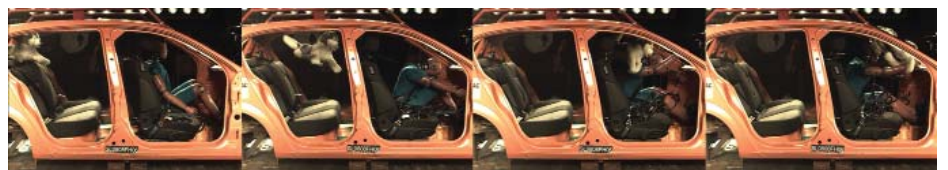
Crash-test avec un mannequin-chien non assuré - vue latérale.
