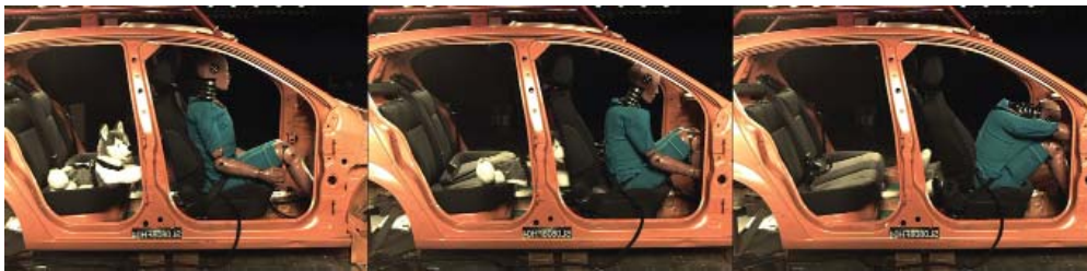
Crash-test avec ceinture de sécurité pour chien - mannequin-chien assuré d'un seul côté.
