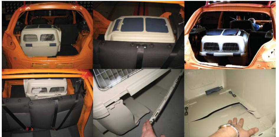
Crash-test avec cage en plastique dans le coffre - mannequin-chien.
